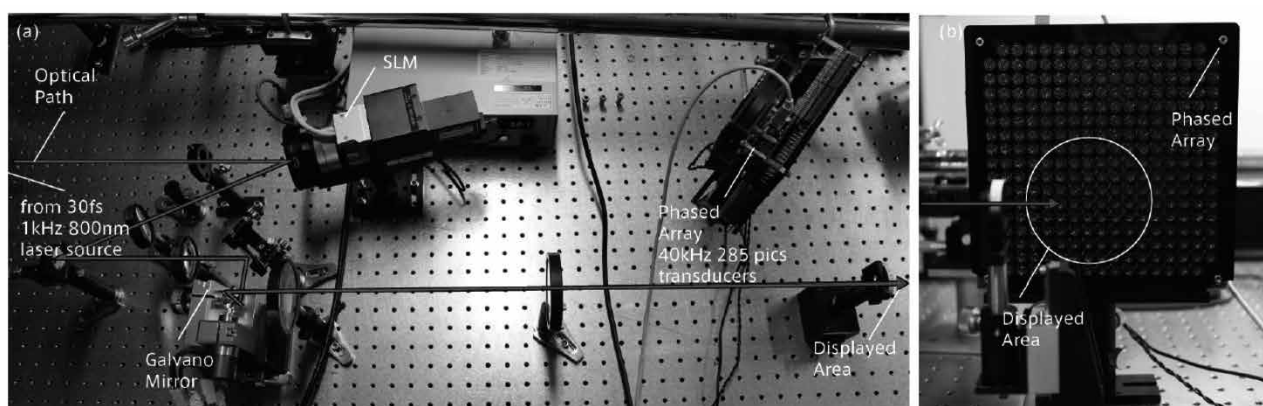
図4 (a) 光学系と超音波系の俯瞰図 (b) 刺激エリアの拡大図 (超音波系と対物レンズの周囲)
